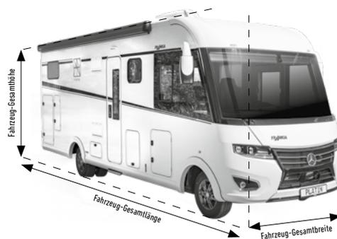
Die **Fahrzeug-Gesamtlänge** entspricht dem Maß zwischen dem äußersten Punkt der Frontschürze und dem äußersten Punkt des Heckabschlusses (ohne Anhängerkupplung).
